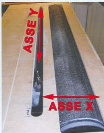
Gli assi di movimento della lastra e della fresa
